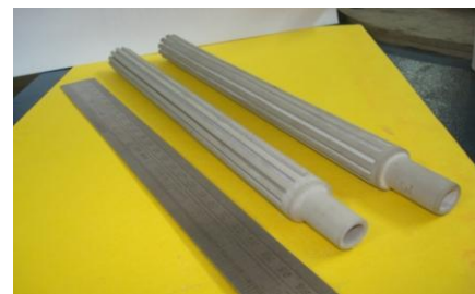
चित्र 1.51 इनबिल्ट वैपर रिमूवल ग्रोव्स के साथ विकसित निकेल विकस
