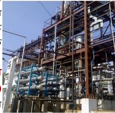
चित्र 1.24 सीएसआईआर – एन ई ई आर आई द्वारा तैयार की गई प्रक्रिया के आधार पर नागार्जुन कृषि रसायन लिमिटेड श्रीकाकुलम में (क) अमोनिया स्ट्रिपर और (ख) दो स्तरीय बायो आक्सीडेशन (टी एस बी) को शामिल करके पूर्ण स्तर की 600 क्यूबिक मीटर/प्रति दिन निर्धारित क्षमता की ई टी पी प्रक्रिया को कार्यान्वित किया गया है।
