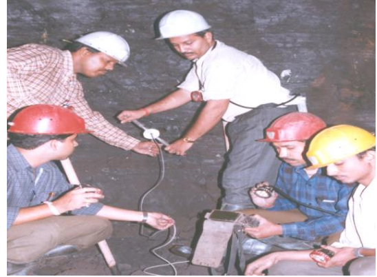
चित्र 1.36 ऊर्ध्वगामी खोड़े गए स्थान में वाइब्रेटिंग कवायर स्ट्रैस मीटर का संस्थापित करना
