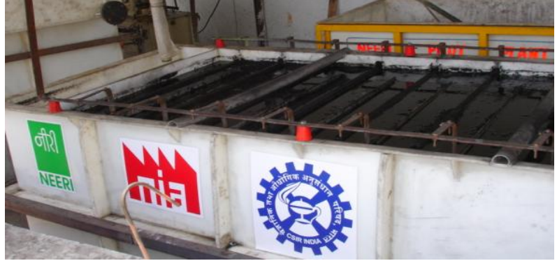
चित्र 1.2.3 नागार्जुन उद्योग गुजरात में कार्बन आधारित इलेक्ट्रोलाइजर यूनिट का प्रदर्शन
